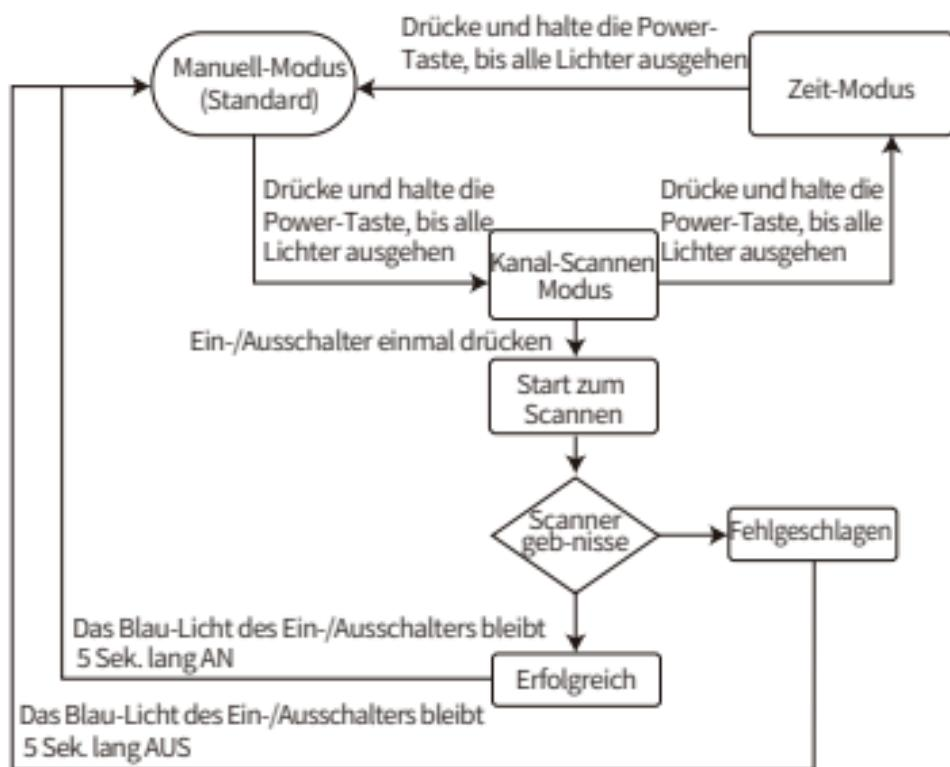
Zeit-Modus: Verwenden Sie den programmierbaren Zeitplan, um den EIN/AUS-Zustand des Smart-Steckers zu steuern. Sein eigener Stromschalter kann seinen EIN/AUS-Zustand nicht steuern.
